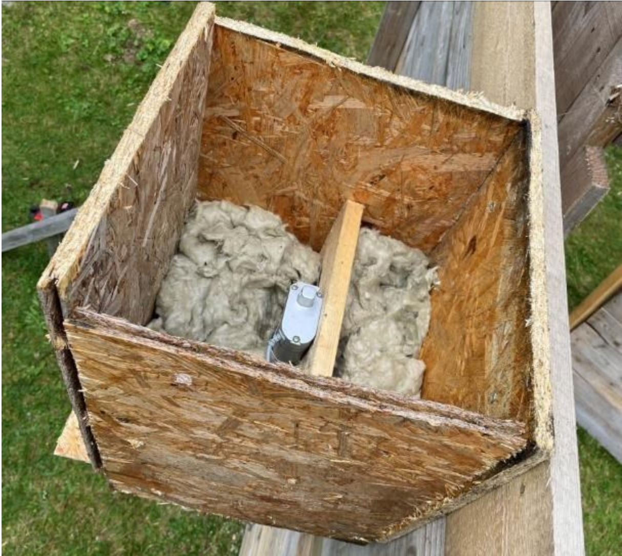
Abbildung 2-4: Hubzylinder in Box mit Dämmmaterial
